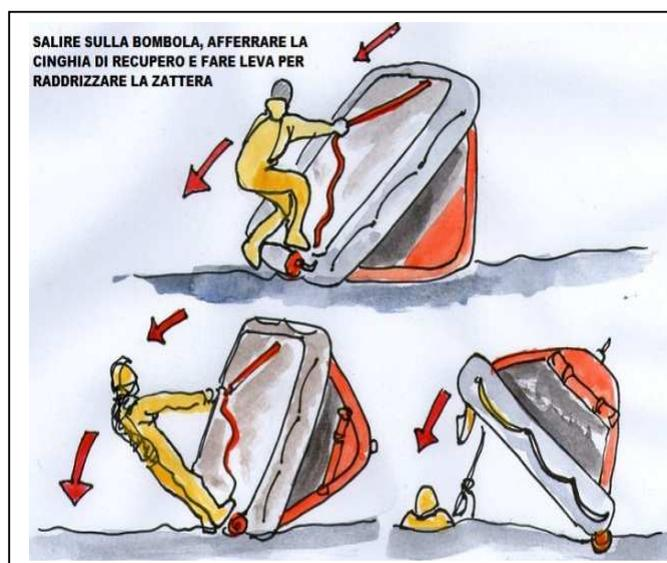
Sul fondo è posizionata una cinghia grazie alla quale, facendo leva con il nostro peso sull'alloggiamento laterale della bombola di gas, potremo "girarla" nella posizione corretta.
